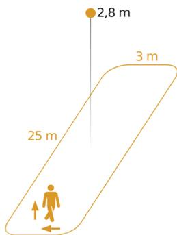
Possibile altezza di montaggio: 2,00 m - 4,00 m
